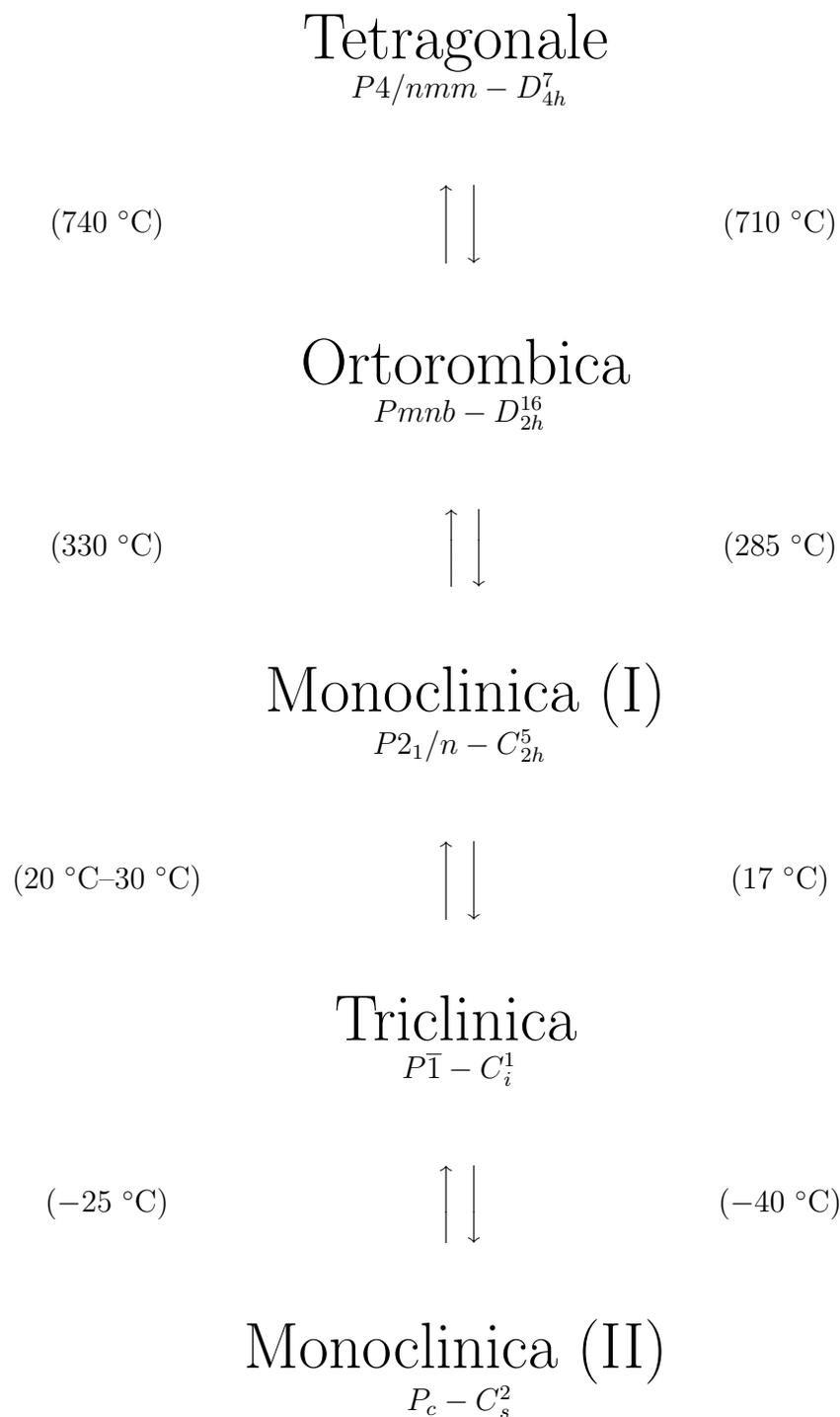
Table 2.1: Fasi cristallografiche distinte del  $\text{WO}_3$ . Sono riportati i sistemi cristallini, i gruppi spaziali e le temperature di transizione di fase. Le temperature di transizione misurate sono indicate con ( $\uparrow$ ) e con ( $\downarrow$ ) a seconda che la transizione avvenga al crescere o al decrescere della temperatura, rispettivamente.
